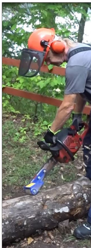
Avbarkning sker med en snurrande hyvel som monteras på en vanlig motorsåg.
