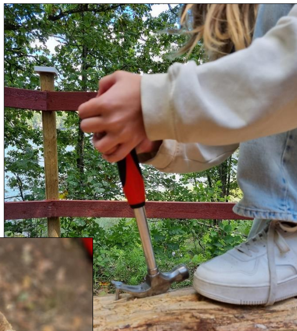
Trots hammarens hävstång kan det vara svårt att dra ur en spik.
