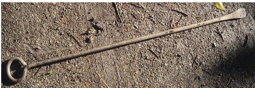
Ett spett som kan vara både en enarmad och tvåarmad hävstång.
