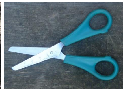
Saxen är en tvåarmad hävstång med en vridningspunkt i mitten.
