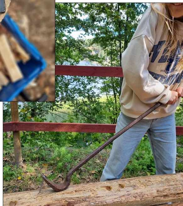
Kofotens hävarm, längden på hävstången, är längre än hammarens och det blir därför lättare att dra ur spiken.
