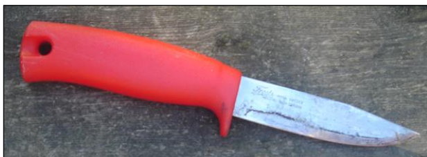
Knivens vassa blad är en kil som kan klyva en träbit eller en lök.
